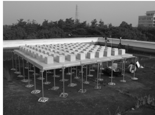
図 4 放射収支観測に用いた模型実験
