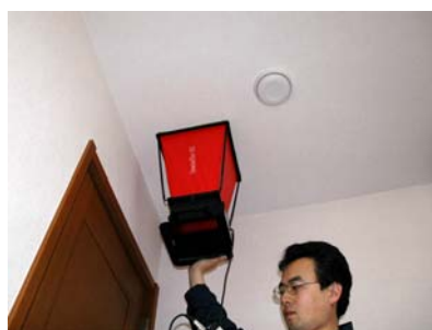
写真-4 風量測定事例 (フード式風量計)
