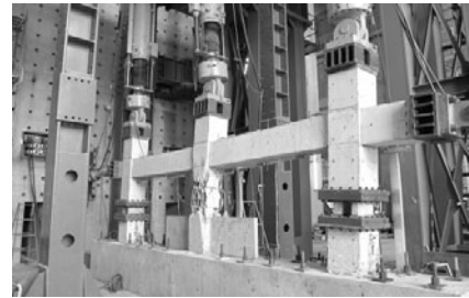
図 3 せん断破壊後の軸力支持能力確認実験
