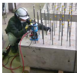
写真 1 付着強度試験 (試験体)
