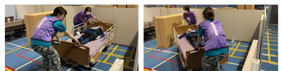
介護用ベッドによる2人体制での介助避難実験の様子
