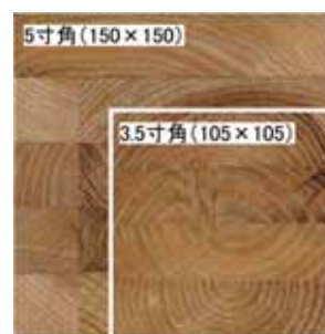
3.5 寸角に比べ約 2 倍の断面積
