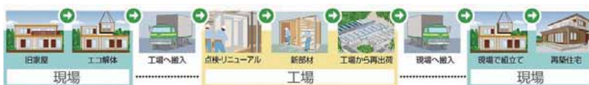
図-1 工場における大規模改修の流れ
