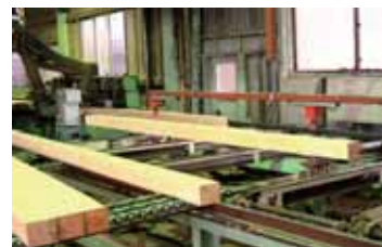
グレーディングマシンによる強度測定
