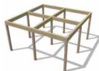
5寸柱によるメインフレーム
