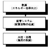
高効率給湯機の採用 ・太陽熱利用システムの導入(付録1-5) ・ガス・石油の場合は、潜熱回収型を選択 ・電気の場合は、ヒートポンプ式を選択 配管ロスの低減・サヤ管ヘッダー工法の採用 ・配管長の短縮・小口径化 湯消費の低減 ・節湯型シャワー・水栓の採用 ・高断熱浴槽の採用
