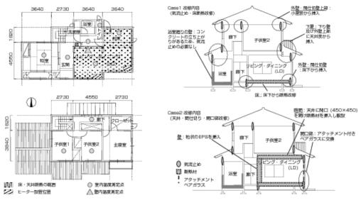
図6 建物概要と断熱改修手法
