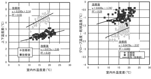
図 18 グローブ温度と乾球温度の差
