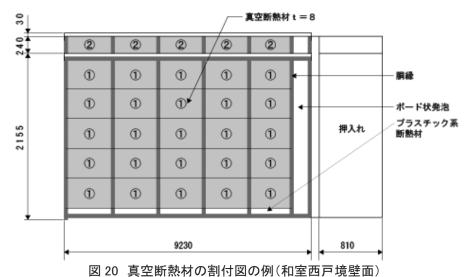
和室西戸境壁では、①と②というモジュールの真空断熱材を使用した。被覆できない部分については、ボ ード状発泡プラスチック系断熱材を使用した。
