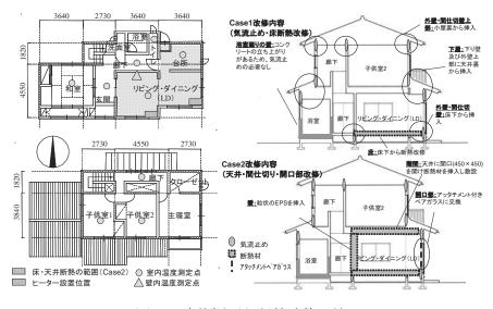
図5 建物概要と断熱改修手法
