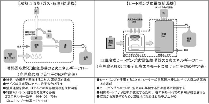
図1 高効率給湯機のエネルギー収支
