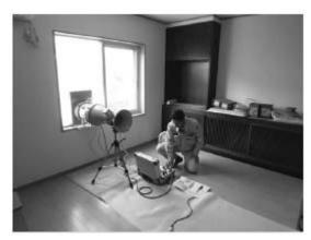
図 12 気密性能測定の様子
