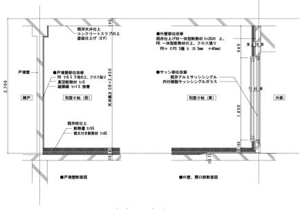
図 21 戸境壁と外壁(東面)の断面図
