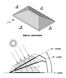
國3 太陽光発電パネルの設置方位と傾斜角による太陽光利用効率
