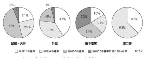
図2 各部位における断熱水準の達成状況 (IV地域)
