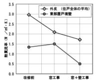
図23 改修前後の部位別断熱性能
