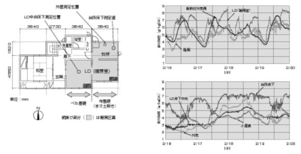
図 19 実験住宅における断熱改修工事後の絶対湿度変化
