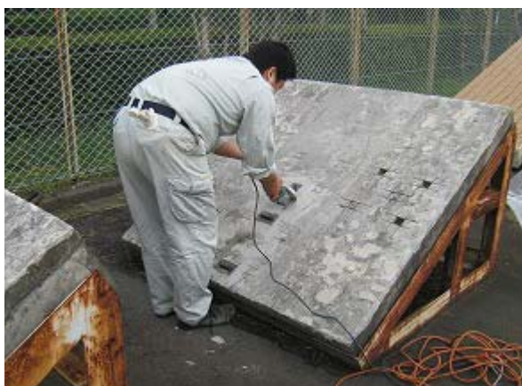
a. 引張試験機用治具の取付け ディスクサンダーで治具周辺に切れ込みを入れる作業。
