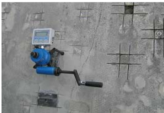
写真 3.12 引張試験準備
