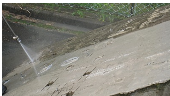
b. 表面観察を行うため暴露試験体表面を高圧水洗浄で洗浄した。
