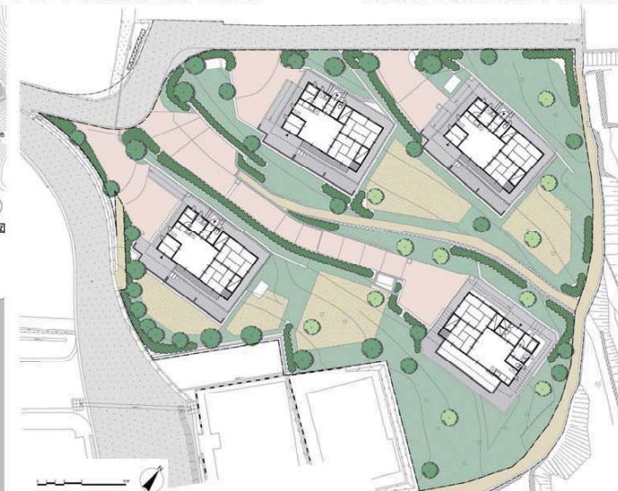
斜面地形に最小限の造成で配置した復興公営住宅(高森C団地)
