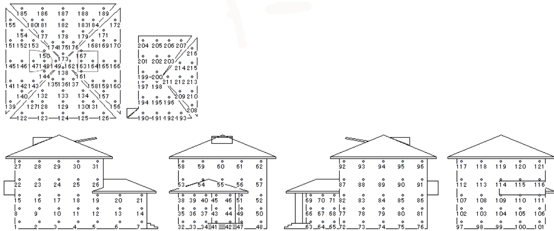
図 2.74 Wind-catcher を持つ屋根の風圧測定孔
