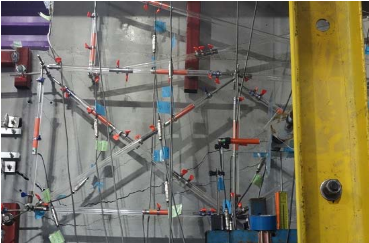
写真 7.2.2 試験体東面変位計取り付け状況(パイルキャップ部)
