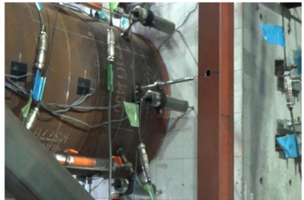
写真 7.4.3 試験体 No. 1 R=-0.5%時の損傷状況
