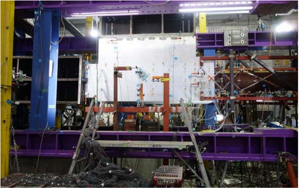
写真 7.2.4 試験体西面変位計取り付け状況
