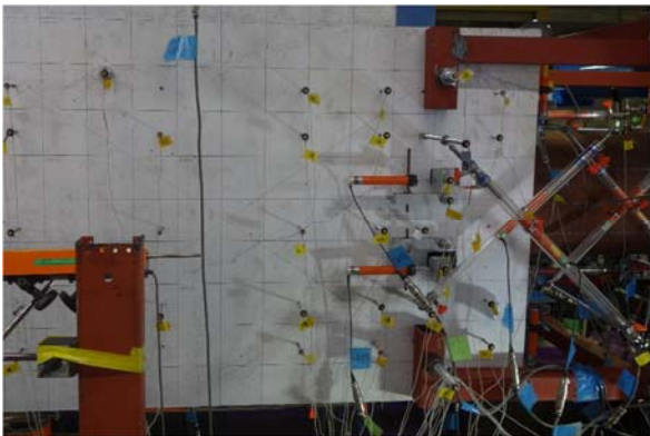
写真 7.4.3 試験体 No. 1 R=-0.5%時の損傷状況
