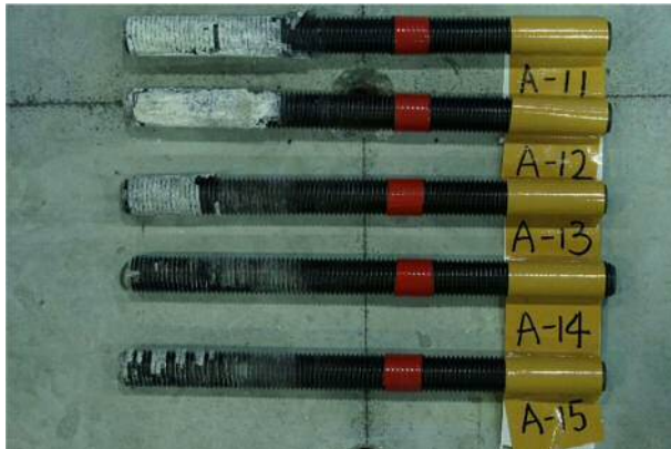
付図 4.2.8 最終破壊状況 ( F_c36 , エポキシ)
