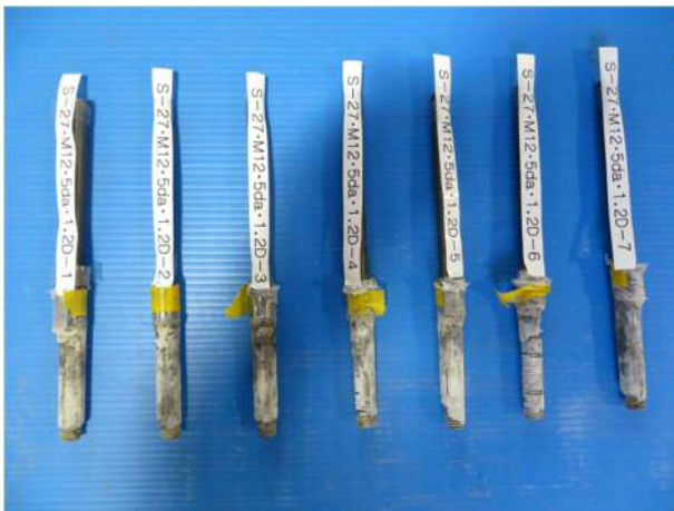
付写真 4.1.21 水準 No. 23_S27・M123・5da・ 座掘径 1.2D
