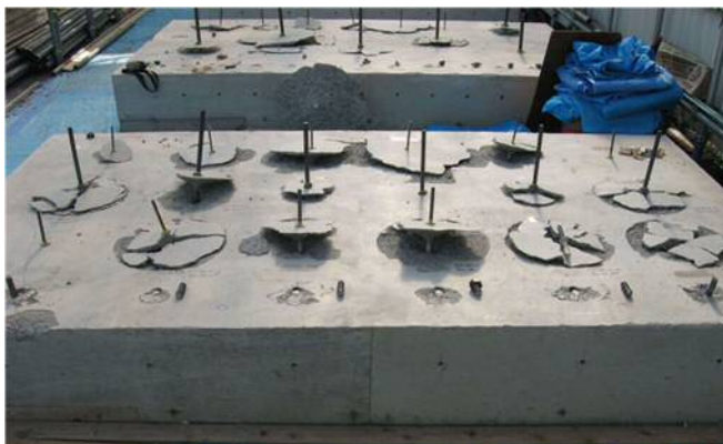
付写真 1.1.3 破壊状況の一例
