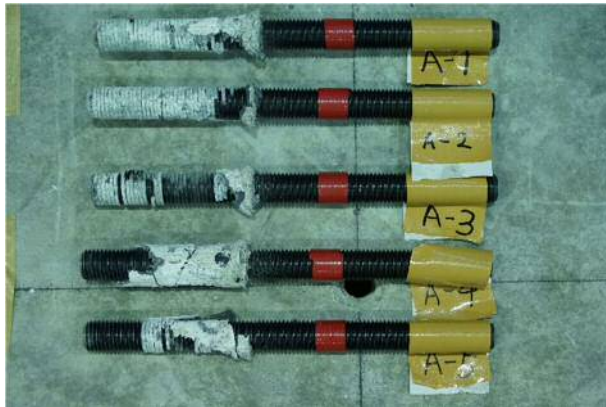
付図 4.2.6 最終破壊状況 ( F_c18 , エポキシ)
