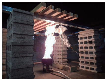
図 7 スノコ状の木質天井材の燃え広がりを把握する火災実験
