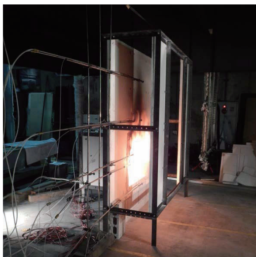
図 2 ダブルスキンにおける噴出火災性状に関する模型実験
