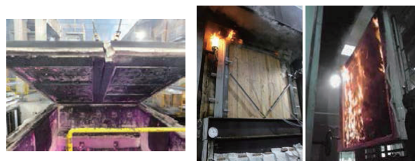
図4 炭化速度測定試験(左)と壁の荷重加熱試験(右)の様子
