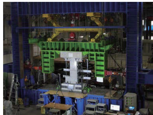
図 3 壁試験体の加力装置
