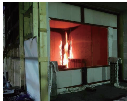
図 8 天井不燃化によりフラッシュオーバーの遅延効果を確認する火災実験
