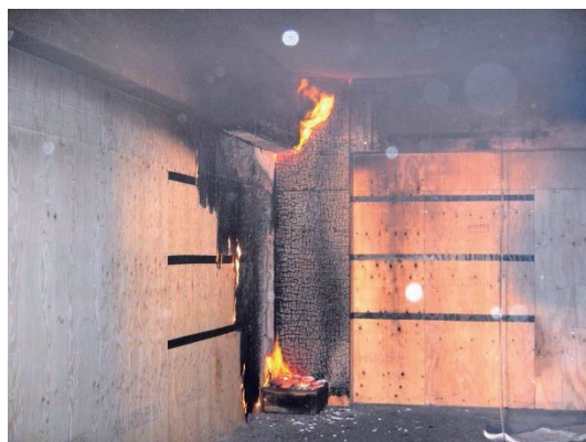
図 3 天井を不燃化した火災実験における木質内装の燃え止まりの例
