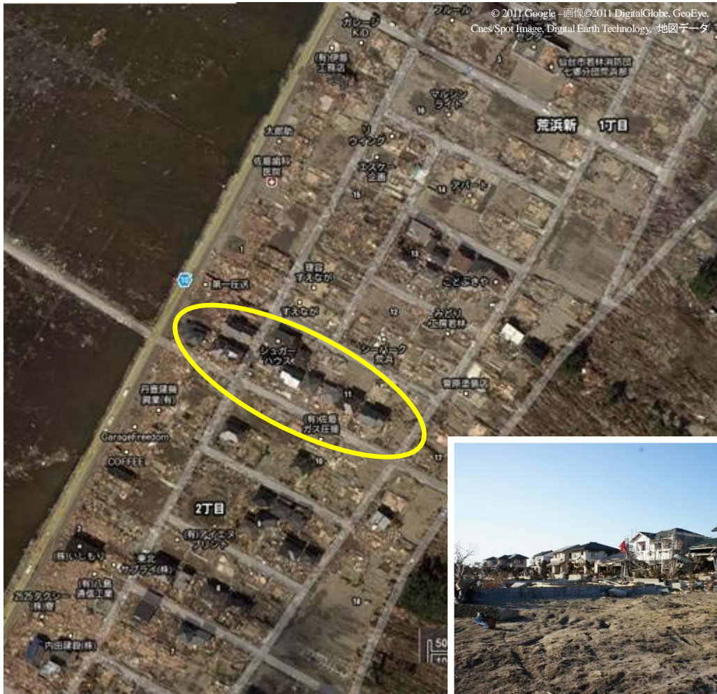
写真 6. 4. 1-5 入射方向先頭に鉄骨造住宅があって列状に残存した木造等住宅群（仙台市若林区）
