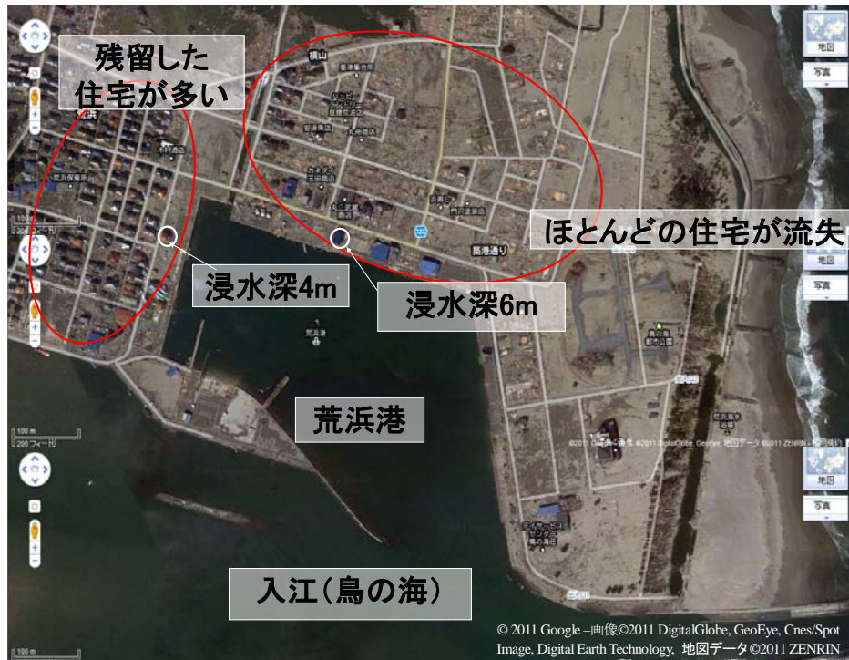
写真 6. 4. 1-15 浸水深 6m でほとんど流失、浸水深 4m でほとんど残存した亘理町荒浜地区の航空写真
