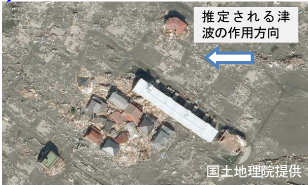
写真 6. 4. 1-3 津波の入射方向に建つ建築物により津波波力が軽減し、残存したと考えられる例（名取市閑上地区）
