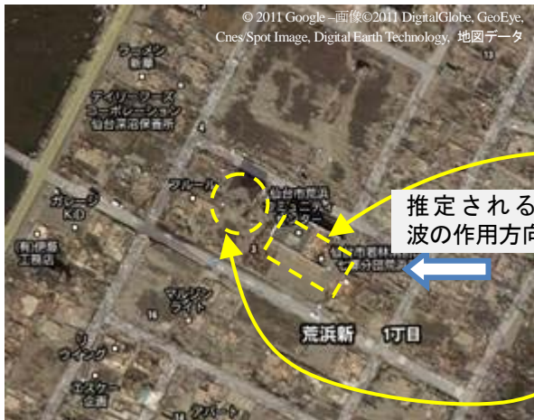
写真 6. 4. 1-4 入射方向に浸水深約 6m の低層 RC 建築物があつて、残存した木造住宅
