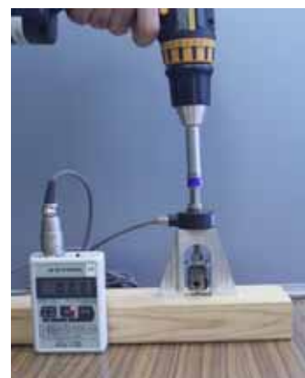
図4 測定法2（現場試験法： 携帯型引抜抵抗測定装置）
