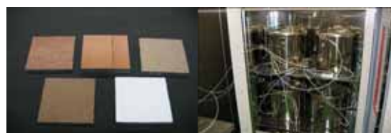
写真-1 各種建築材料及び試験装置： 左上から、合板、フローリング、パーティクルボード、 MDF、EPS
