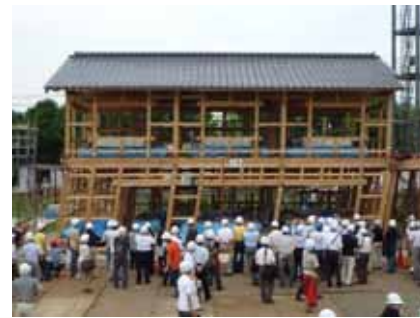
写真 1 実大静的加力試験 - 試験体 A 棟の大変形時の様子
