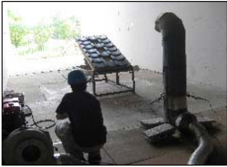
「火の粉が飛び散る様子の観察」 火災の火の粉が風に乗って運ばれる様子を実験で観察しました。
