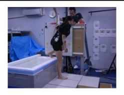
床反力計により姿勢安定性の確認が可能 (浴槽跨ぎ高さ・手すり位置の検証の例)
