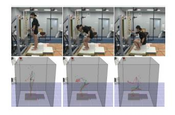
姿勢・動作等の情報を建築の3次元モデルに適用 (モーションキャプチャによる測定結果の例)
