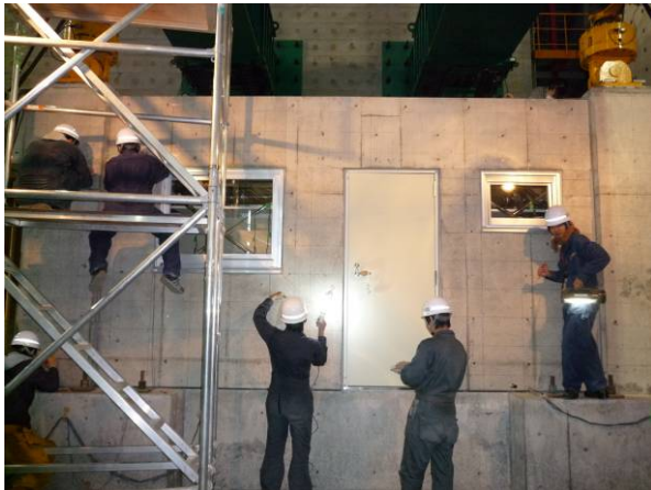
写真4 加力実験全景
