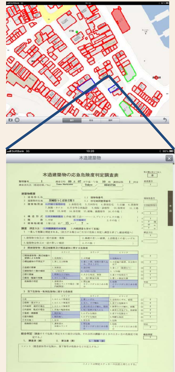
応急危険度判定の画面
