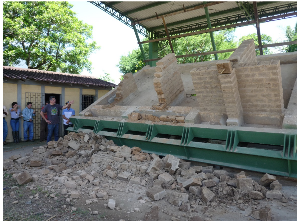
H28 エルサルバドルでの在外研修 (傾斜台での組積造構造実験)
