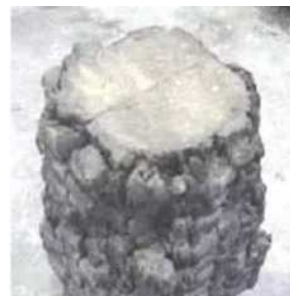
加熱を受けた木質柱の断面
