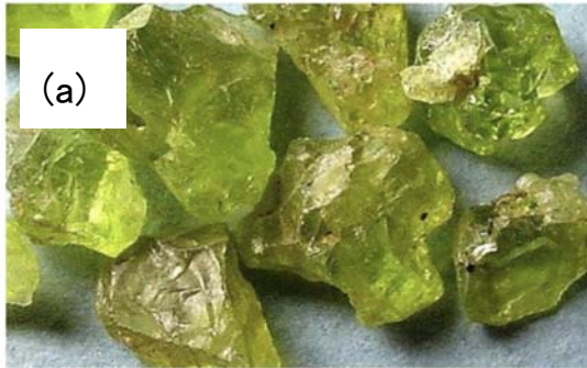
図4：フランスの研究グループ（第二著者Thomas Ferrand研究員を含む）の室内実験結果に用いられた、岩石試料（マントル物質を想定）の作成時の写真。サンカルロス産の橄欖（かんらん）石（図4a, 橄欖岩を主に構成する鉱物）とコルシカ産の蛇紋石（図4b, 蛇紋岩を主に構成する鉱物）の割合を人工的に調整の上、機械（図4c）を用いて1.5Gpaの圧力と500度の温度環境に約10時間置くことで、人工的にマントル岩石を作成します。
