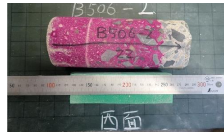
中性化深さ測定
