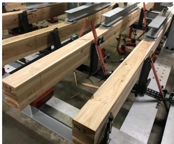
炭素繊維束挿入集成材・炭素繊維束単体のクリープ試験
