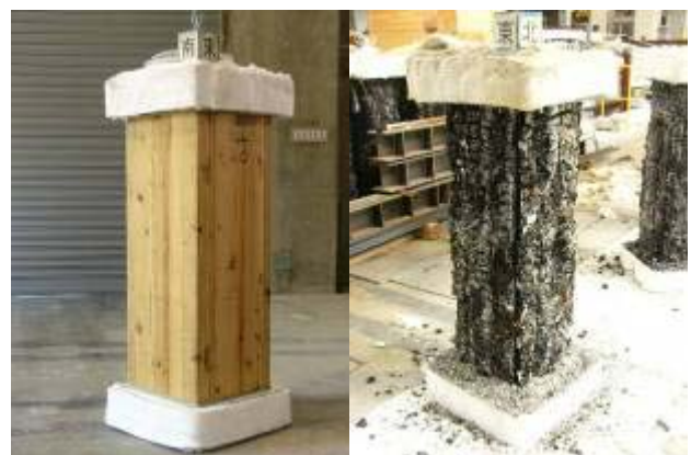
図 3 加熱試験前後の短柱試験体
