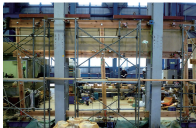
写真16 試験体Cと同一仕様の静加力実験後
