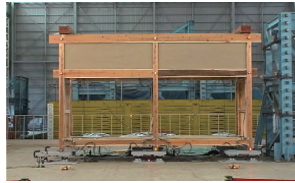
写真15 試験体D JMA神戸NS100% 加振後
