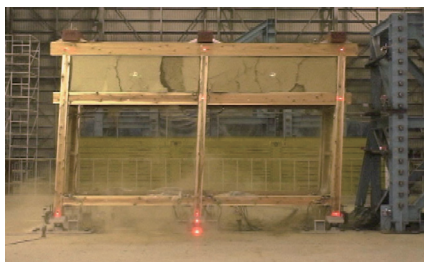
写真12 試験体A JMA 神戸 NS100% (重錘3ton) 加振中
