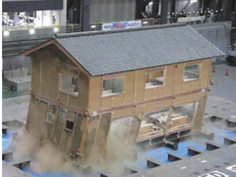
写真7 A棟のJR鷹取による加振時の様子
