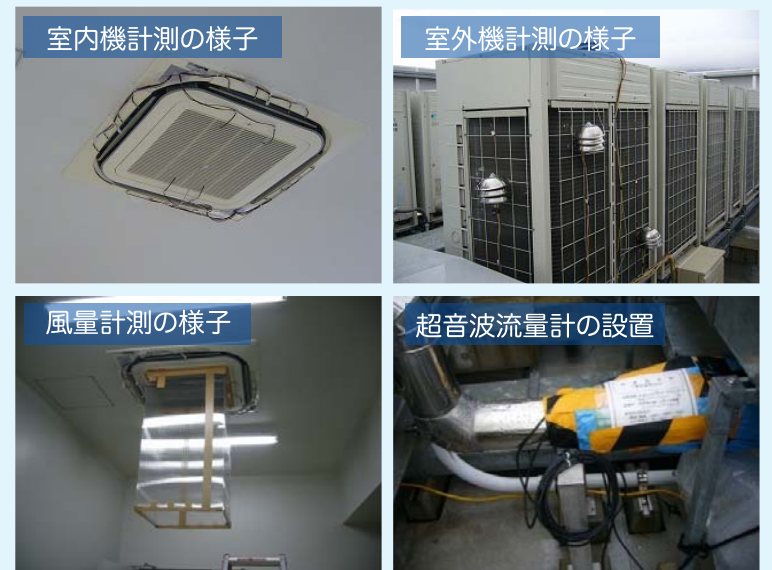
図5 個別分散型空調機の実動特性計測の様子
