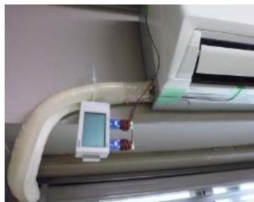
エアコンの稼働状況の実測
