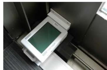
窓の開閉状況の実測
