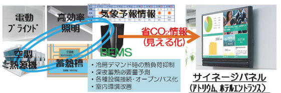
図 5 BEMS 改修と電力見える化
